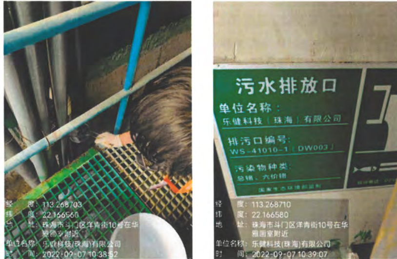
图3 含铬废水预处理口 (WS-41010-1) 采样照片
